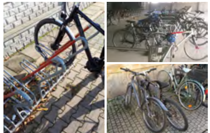
Abb. 2: Fahrradabstellanlage mit einseitiger Einstellung (links), Fahrradabstellanlage mit zweiseitiger Einstellung (rechts oben), Fahrradabstellanlage mit Doppeleinstellung (rechts unten)
